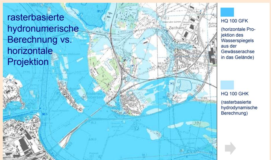
Abb. 29: Unterschiede des Flächenumgriffes des 10 m-Wasserstandes bei Extremhochwasser der Gefahrenhinweiskarte im Vergleich zur Gefahrenkarte in Sachsen (Seifert/Elze, in: Seifert 2012b: 8)
