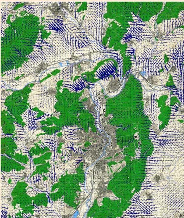
Mittlere Strömung im Überdachniveau (50 m über Grund) später in der Strahlungsnacht, mehr als 3 Stunden nach Sonnenuntergang bzw. in der zweiten Nachthälfte. Die Strömung ist dargestellt durch Vektoren an jedem 2. Berechnungspunkt. Die Länge der Vektoren ist ein Maß für die lokale Geschwindigkeit.
