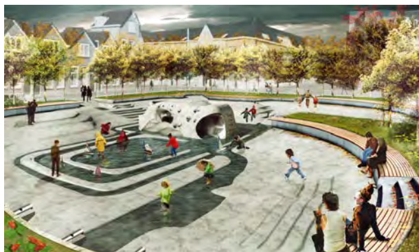
Beispiel aus Rotterdam für die multifunktionale Nutzung von Freiflächen für den Hochwasserschutz (De Urbanisten 2010)
